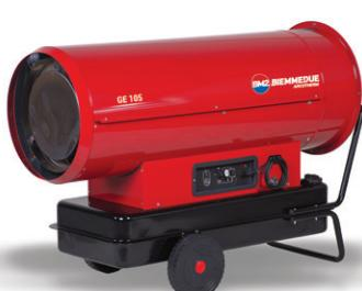
**GE:** alimentati a gasolio, con bruciatore integrato, a combustione diretta: i residui della combustione vengono espulsi con l'aria calda prodotta dal generatore e contribuiscono al suo riscaldamento, per questo motivo hanno un rendimento del 100% ovvero trasformano tutta la potenza bruciata in potenza termica resa. Sono i più economici, anche per quel che riguarda l'esercizio ma per contro possono essere impiegati solamente in locali areati.
