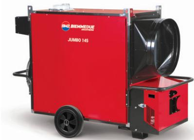
**JUMBO:** a combustione indiretta, macchine di grande dimensione per ambienti più voluminosi, possono montare indifferentemente un bruciatore esterno a gasolio, GPL o metano. Equipaggiate con ventilatore assiale rispondente alle normative ERP 2015 sono un ottimo compromesso per rendimento (93%), silenziosità e prevalenza, caratteristica consigliabile in particolare per montaggi ove sono previste canalizzazioni.
