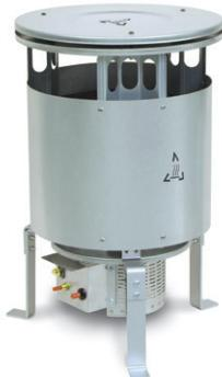
**GW:** alimentati a GPL in alta pressione (1,5 bar), con bruciatore integrato ed a combustione diretta. Autonomi, non necessitano di alimentazione elettrica, l'accensione è manuale tramite piezoelettrico. Per la loro alimentazione vengono in genere collegati alle bombole di GPL, il che li rende maneggevoli e molto economici.
