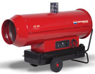
**EC e PHOEN:** alimentati a gasolio, con bruciatore integrato (EC) e separato (PHOEN) dal ventilatore, a combustione indiretta: impiegano uno scambiatore di calore che permette l'evacuazione dei fumi attraverso un camino collegabile con l'esterno; possono quindi essere collocati all'interno di locali chiusi, per contro hanno un costo più elevato ed un rendimento intorno al 90%, dovendosi calcolare, in riduzione, la quantità di calore evacuata attraverso il camino.
